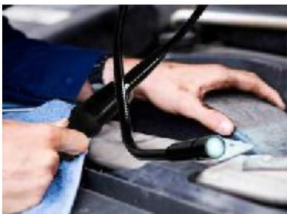
Достоверно оценить состояние механических деталей автомобиля поможет только визуальный осмотр. Если с ходовой частью никаких проблем обычно не бывает, то заглянуть в труднодоступные места можно только с помощью специальной техники. В медицине, аэрокосмической отрасли для этого уже давно используют эндоскоп с камерой, сегодня данный прибор доступен всем техническим службам. С его помощью можно провести осмотр двигателя и трансмиссии без предварительной разборки этих сложных узлов.
